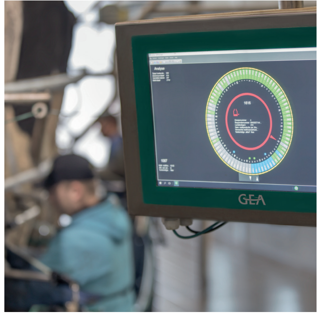
Выполняемые в настоящее время работы на доильном месте отображаются на мониторе.
